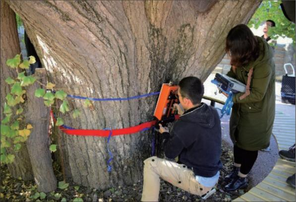
用树空洞探测仪器检测石景山一级古银杏树
